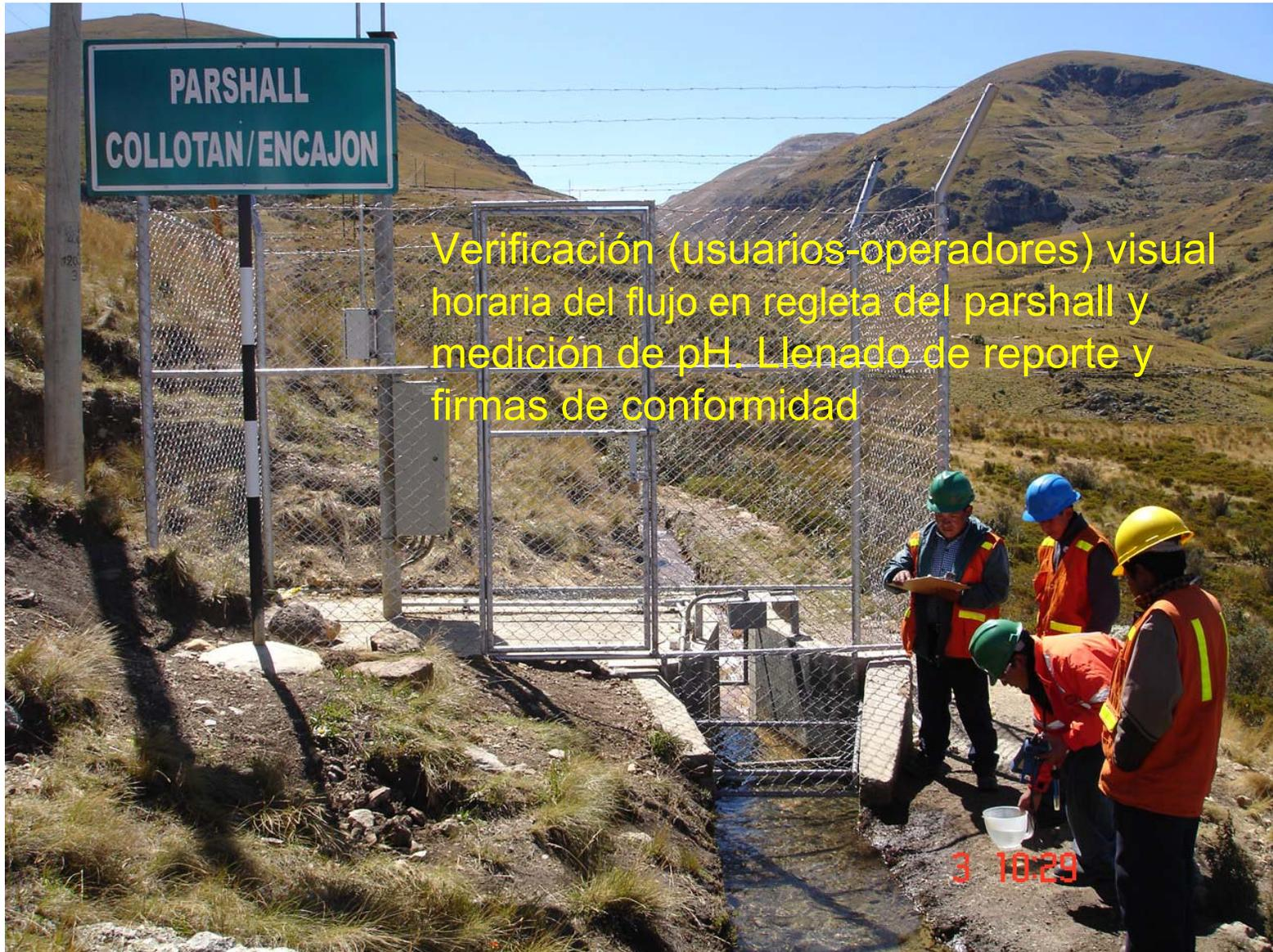
Verificación (usuarios-operadores) visual horaria del flujo en regleta del parshall y medición de pH. Llenado de reporte y firmas de conformidad
